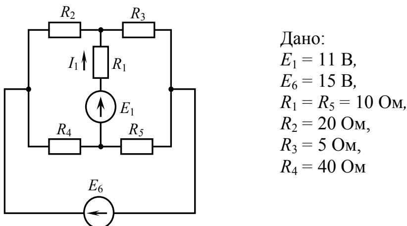
Определить ток  $I_1$  методом эквивалентного генератора и проверить результат методом наложения.
